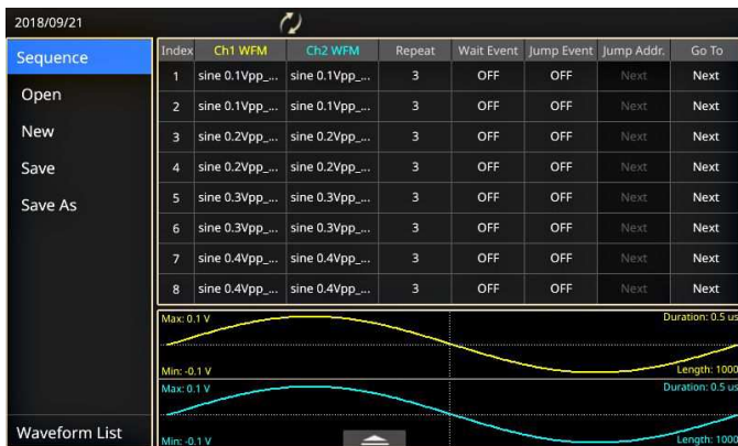
В расширенном режиме можно создавать сложные сигнальные последовательности и гибко управлять их шагами
